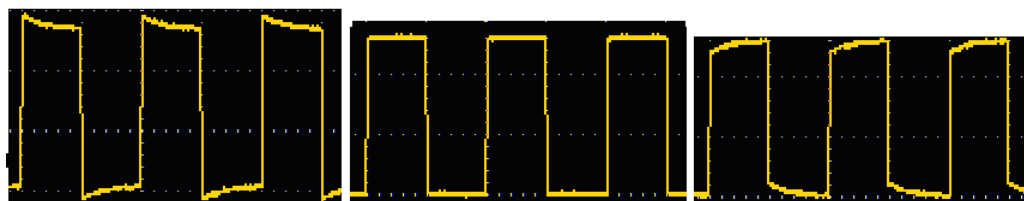
図 3 -5： プローブ補償の表示波形
